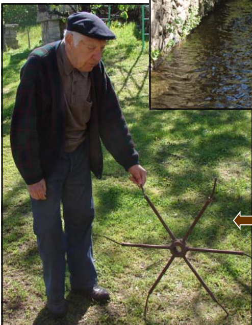
Paul Ollier montrant l'une des armatures métalliques d'une machine, appelée blutoir ou bluteau (*), destinée à tamiser la chaux.
