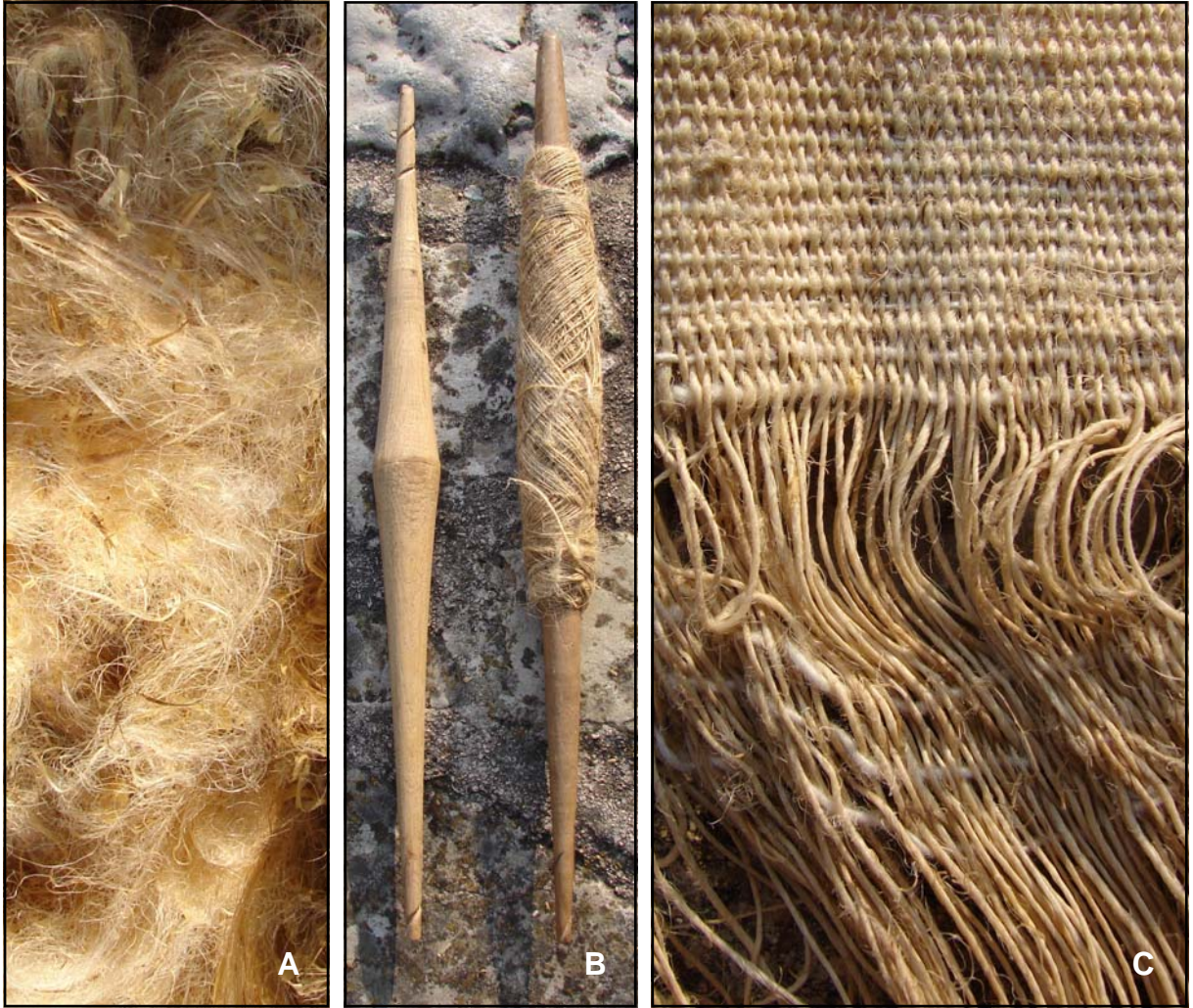
A - Filasse de genêt obtenue après rouissage, B - Fuseaux, C - Début d'un tissage (Collection MT Marc) D - Toile de genêt et son grossissement (collection M. Commeignes)
